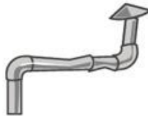
Tiros de humo en mal estado
